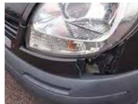
Gebroken, gebarsten, vervormde of losgelaten bumpers, grills of stootstrips
