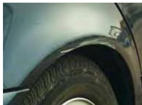
Krassen tussen de 2 en 10 cm in een grotere hoeveelheid dan aanvaardbaar geacht
